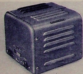
Bild 18. Eine 25-W-Endstufe in zweckmäßiger Tischbauweise von Telefunken
